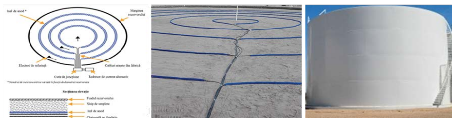
Figura 13 Schema și imaginea de ansamblu a unui sistem cu inele de anozii concentrice
