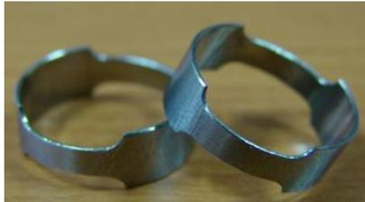
**Figure 2.** „Ring tensile test” samples
