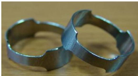
Figure 5. „Ring tensile test” samples
